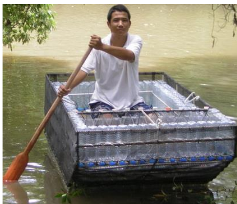
รูปที่ 4 อุปกรณ์ลอยน้ำในภาวะวิกฤติเนื่องจากอุทกภัย
